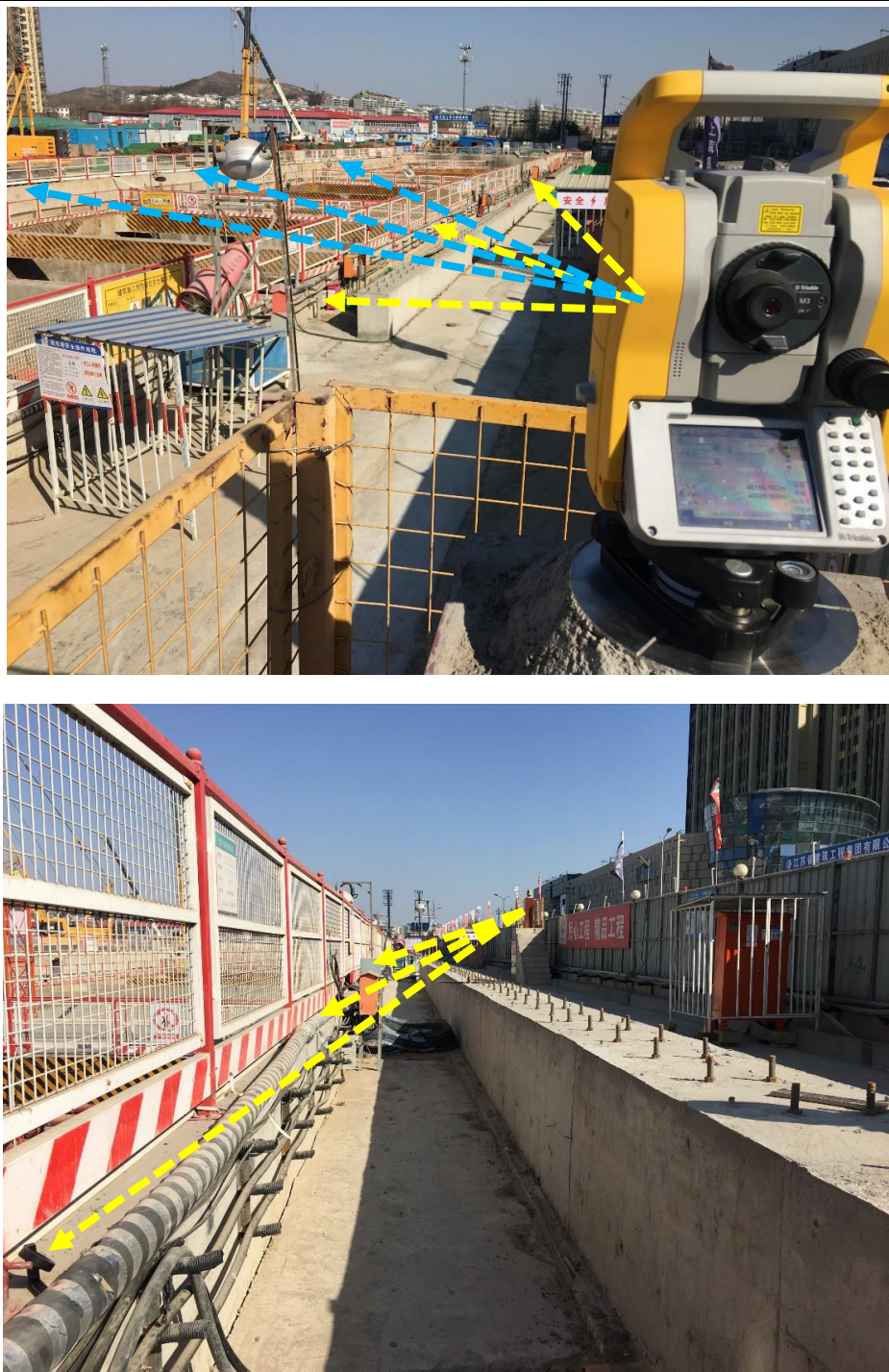
图 8.10 监测点安装位置及棱镜朝向定位图
