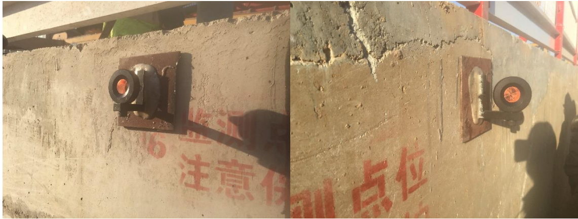
图 8.5 基坑北侧小棱镜布设实例图
